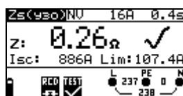
Рисунок 5.33: Пример результатов измерения сопротивления контура с использованием функции блокировки срабатывания УЗО
