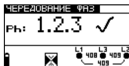
Рисунок 5.39: Пример результатов проверки правильности чередования фаз
